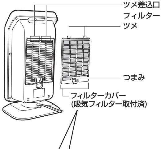
吸気フィルターはお手入れのあと、フィルターカバー裏面にあるフィルター固定用ツメ（4か所）に吸気フィルターを取り付けてください。
