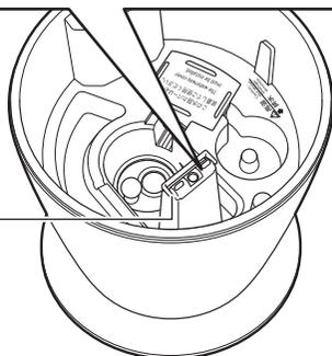
加湿運転時には中にあるファンモーターが回り、送風口から風が出て、発生したミストを上へ吹き上げます。お手入れ時に水を入れないうように十分に注意してください。
