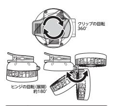
できるだけヒンジを開いて、吸気口部分を 大きく開くようにする。
