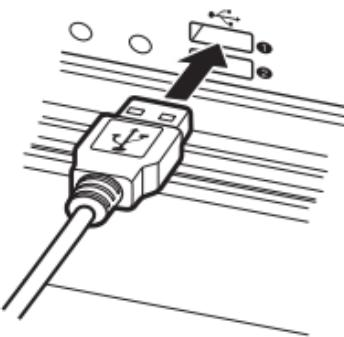
4. USBケーブルのマイクロUSBプラグを本体のUSB端子に接続する
