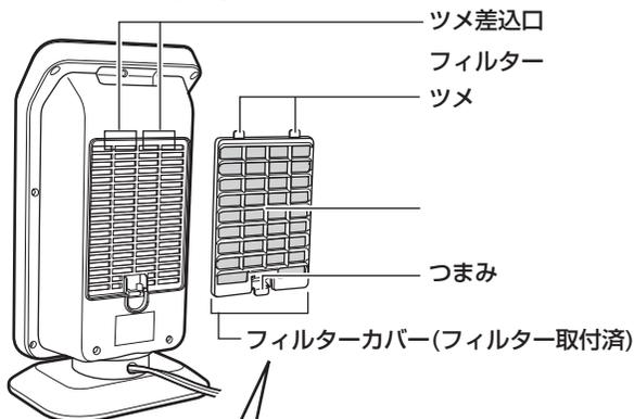
フィルターはお手入れのあと、フィルターカバー裏面にあるフィルター固定用ツメ（4か所）にフィルターを取り付けてください。
