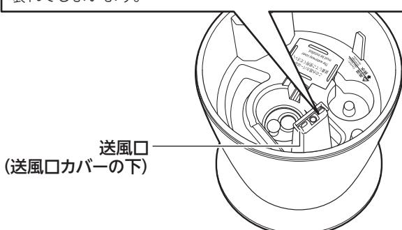
加湿運転時には中にあるファンモーターが回り、送风口から風が出て、発生したミストを上に吹き上げます。お手入れ時に水を入れないよう十分に注意してください。
