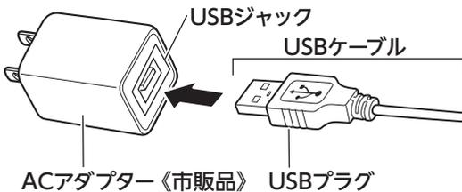
※本機はUSB標準の5V0.5Aでも動作しますが、使用するACアダプターは、5V1A以上のものを推奨。
